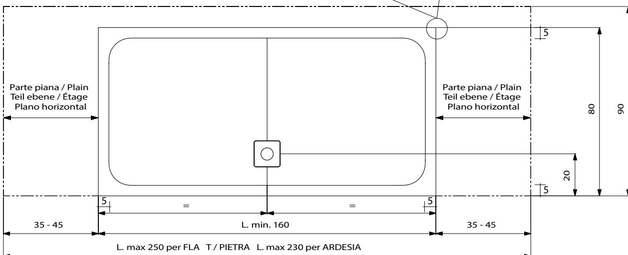
Montaggio in appoggio DX-SX - Floor assembly R-L - Bodenausführung R-LMontage en appui DR-G - Montaje en apoyo Dcha-Izda**1 DX - SX**
