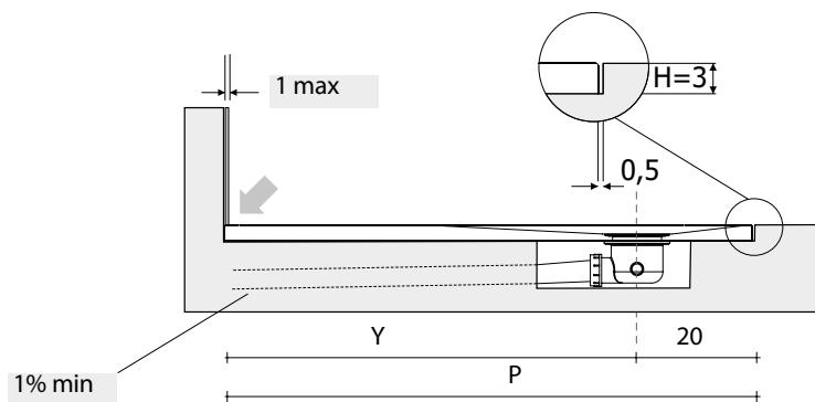
Montaggio ad incasso CX - Embedded assembly CX - Eingebaute Ausführung CX
